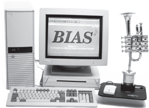
Abb. 88: Aufbau des BIAS Meßsystems. Neben dem Computer und dessen Bedienelementen ist das BIAS-Subsystem unterhalb des Monitors abgebildet, sowie der Meßkopf, in den ein Mundstück einer Trompete eingespannt ist.
