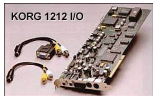
Abb. 200: Audio-Interface Karte die zum Harddiskrecording verwendet wurde.
