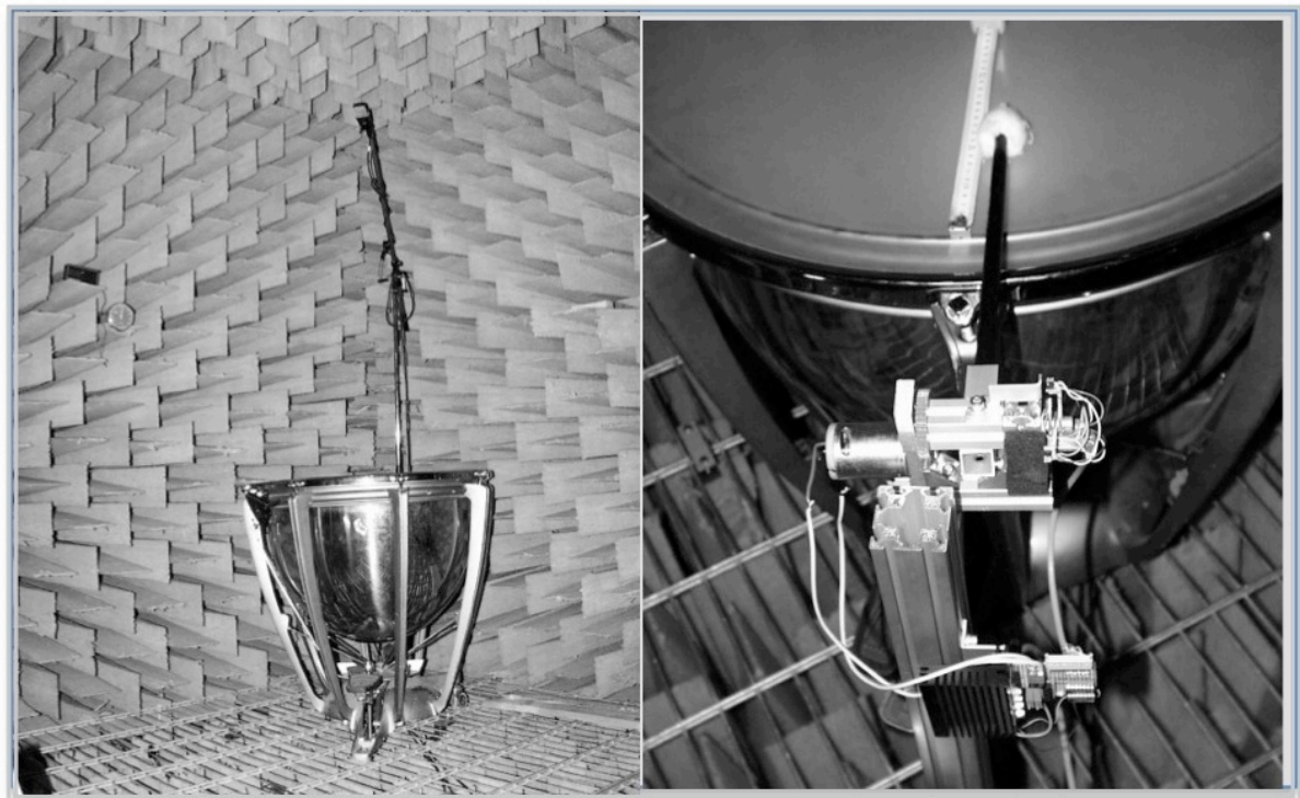
Setup der Klangaufnahmen im reflexionsarmen Raum. Die Anregung erfolgte mittel elektronisch gesteuertem (reproduzierbarem) Anschlag
